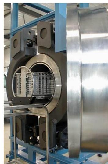
Autoclave haute pression avec fermeture automatique.
