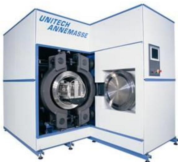
Machine au CO<sub>2</sub> SuperCritique et au CO<sub>2</sub> liquide sous pression.
